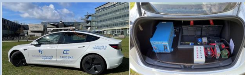
Abb. 1: Aufbau des Forschungsfahrzeugs Tesla Model 3 mit zusätzlicher Umfeldsensorik (Kameras, Radar, Lidar) auf dem Dach und dem restlichen Aufbau (CarPC, Stromversorgung, Verkabelung, ...) im Kofferraum Quelle: THI
